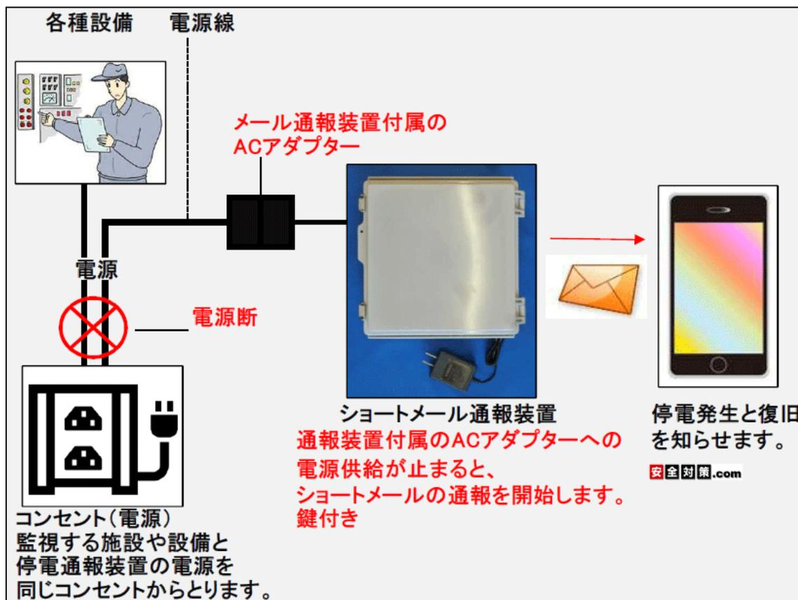
FOMA 無線モジュールとアンテナが組み込んでありますので、一般電話回線が無い施設の設備の遠隔監視が可能です。携帯電話機は不要です。FOMA SIM カードをご契約いただくだけでご使用できます。
